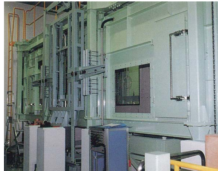
強風シミュレーション風洞 Boundary Layer Wind Tunnel
